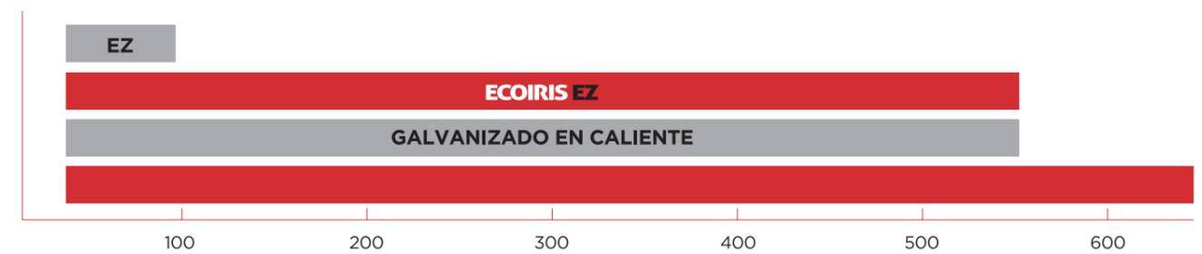
Número de horas en ensayo de niebla salina neutra (NSS) según ISO 9227, sin que se produzca la aparición de óxido rojo (<5% de la superficie total)
